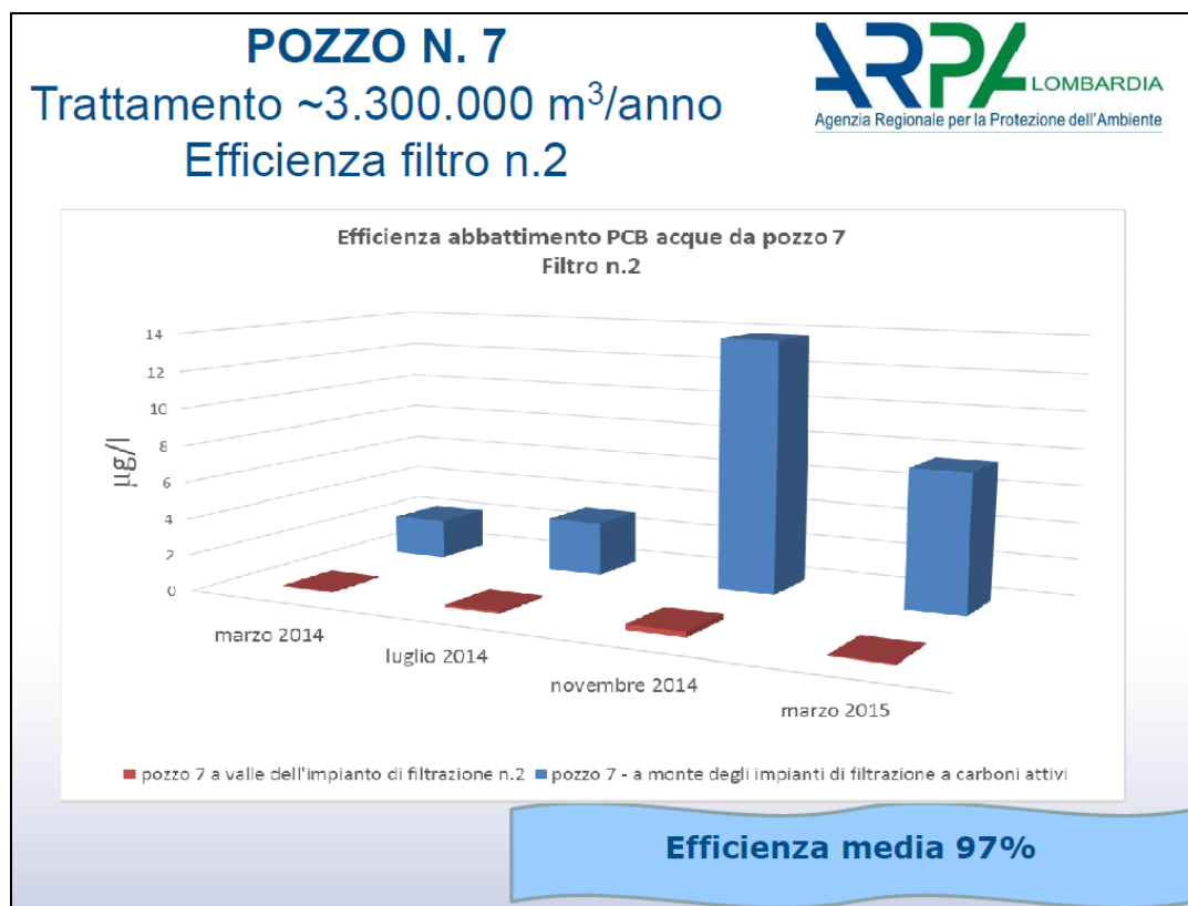
Immagine 17: efficienza di rimozione dei PCB della batteria di filtri n.2 che tratta il 50% della portata di acqua emunta dal pozzo 7 – dati ARPA
